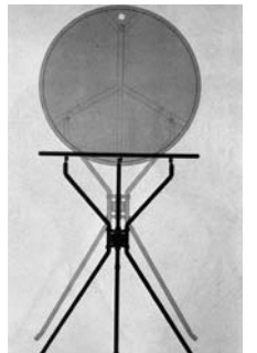
Dessin de la table Cumano . Pour signifier l'idée d'un objet pliant, il a suffi de percer un trou au bord du plateau. Dans cet objet, imaginé au XIXe siècle, la notion « d'accrocher » s'associe à celle de « ranger ». Bien que la forme évolue peu, la mise au point technique de la table a été un exercice complexe. Il s'agit d'un travail sur les proportions de l'ensemble.
