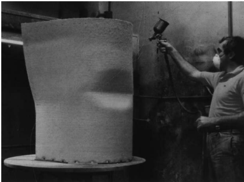
Ouvrier pulvérisant de la résine polyester sur le feutre du fauteuil Feltri , Gaetano Pesce, Cassina, 1987.
