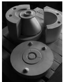
Moulage de la barbotine dans un moule en plâtre.
