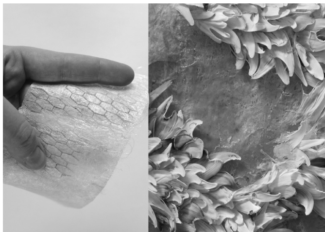
Fig. 1. — Non-tissé de fibres Polyfloss texturé par découpe laser (gauche) et non-tissé combinant fibres et flocons Polyfloss (droite), atelier partagé avec the Polyfloss Factory, 2015. ©ENSAD
